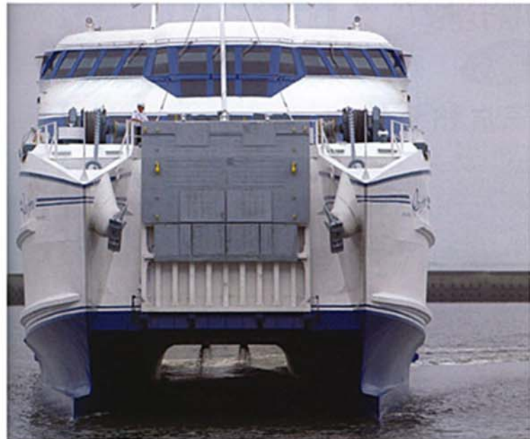
きわめて細い胴体に構造物が載る。試運転時の最大速度は31.3ノット(時速約58km)。中・小型カーフェリーとしては異色の高速だ。
