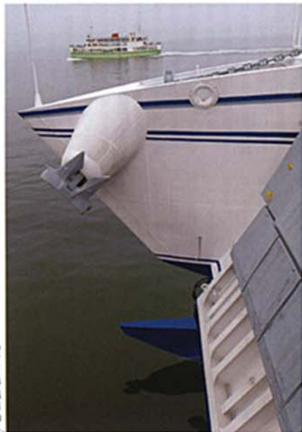
熊本～島原外港間はふたつのフェリー会社が運航している。僕にとっては、ライバル会社のクラシカルな姿のフェリーを軽快に追い越すシーンも見られる。写真では、アンカーが双胴の内側についているのがわかる。
