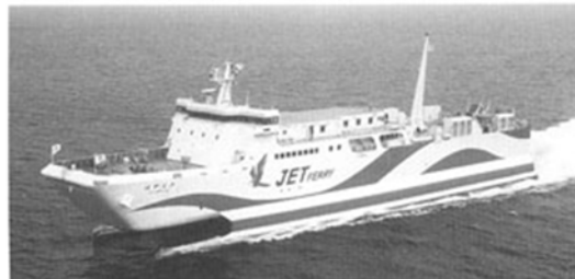
九四フェリーの「はやぶさ」。波浪型高速フェリーで、トラックを多めに搭載した場合、所要の速力が発揮できなかった。
