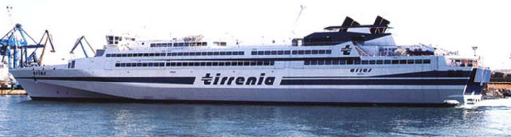
↑アリエス Aries (ティレニア・ライン) イフィンカンティエリ社が開発したMDV3000ジュピター型で、伊ティレニア・ライン向けに4隻建造されたうちの1番船。1998年に竣工した。チビタヴェッキア～サルデーニャ島航路などに就航している。11,347総トン、全長145.6メートル、速力40ノット、船客定員1,800名、乗用車460台搭載。現在世界最大のモノハル型高速カーフェリーである。(船集部)
