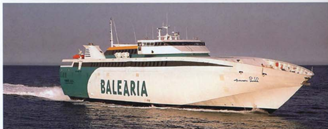
↑ラモン・ルル Ramon Llull (バレアリア) イロドリゲス社のアクアストラーダTMV84型と称するタイプで、2003年6月に竣工した。スペインのバレアリア社がミノルカ島シウダデラ・マヨルカ島アルクディア航路で運航している。2,620総トン、全長83.4メートル、速力35ノット、船客定員479名、乗用車100台搭載。(RODRIGUEZ)
