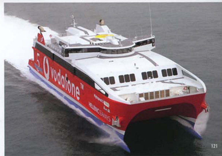
→ハイスピード 5 Highspeed 5 (ヘレニック・シーウェイブ) オースタル社のオート・エクスプレス85型で、昨年7月に引き渡された。ビレウス～チャニア(クレタ島)航路に就航している。4,913総トン、全長85メートル、最高速40ノット、船客定員809名、乗用車154台搭載。ヘレニック社には、本船以前に72メートル型2隻、92メートル型1隻の3隻がオースタルから引き渡されている。(AUSTAL)
