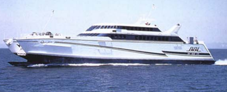
←オーシャンアロー Ocean Arrow (熊本フェリー) 石川島播磨重工業が開発したSSTH (超船長双胴船) 型と呼ばれる高速カーフェリーで、1998年3月に竣工した。熊本～島原を30分で結んでいる。1,687総トン、全長72.1メートル、最高速31.3ノット、船客定員430名、乗用車51台搭載。他船に比べて速力が低いが、現在わが国で唯一就航しているタイプなので収録した。(熊本フェリー)
