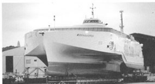
オースタル社が開発した世界初の三胴型高速フェリー、ベンチヒグア・エクスプレス Benchijigua Express。(AUSTAL)
