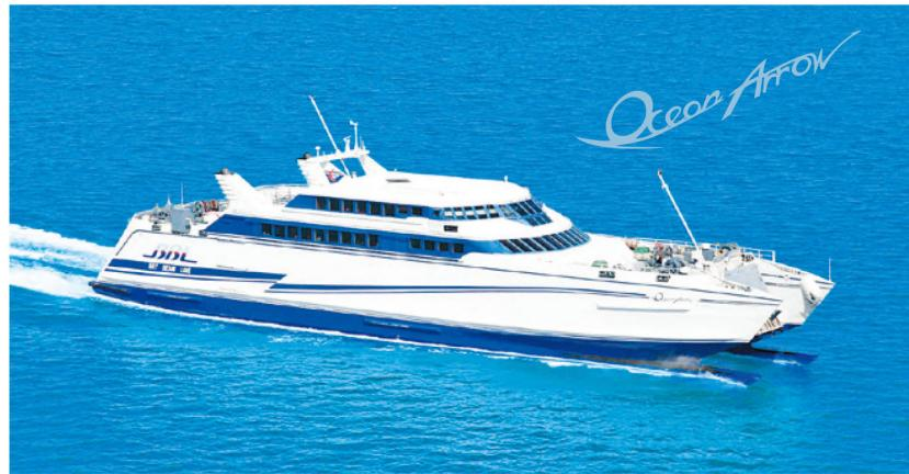
オーシャンアロー 最大速力は30ノット(時速約55キロ)、1674t、全長72m、乗用車51台(または大型バス9台)積載可能
